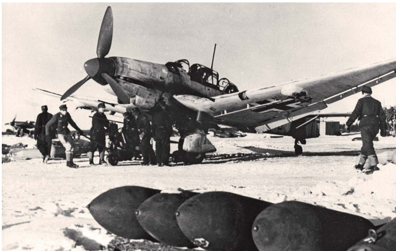
Junkers Ju 87 D-5 Stuka během přípravy k bojovému letu. Příslušníci pozemního personálu právě upevňují pumu pod jeho trup, další 4 bomby menších ráží budou následně umístěny pod křídla, 20 mm kanóny v křídlech se osvědčily proti nepancéřovaným pozemním cílům. (www.airwar.ru)
